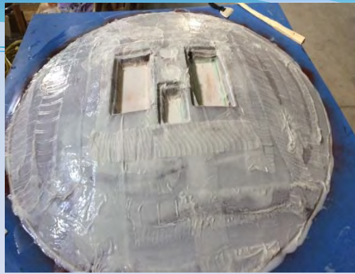
Заливка мастер модели непотопляемого корпуса силиконом с тканевым армированием
