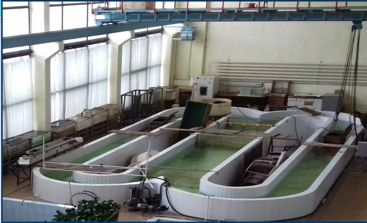
Общий вид испытательного бассейна с возможностью создания течения
